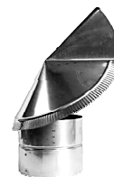
Κεφαλή με εκτροπέα. Αλλάζει την κλίση της με τον άνεμο και προσφέρει πολύ καλή απαγωγή καπνού.
